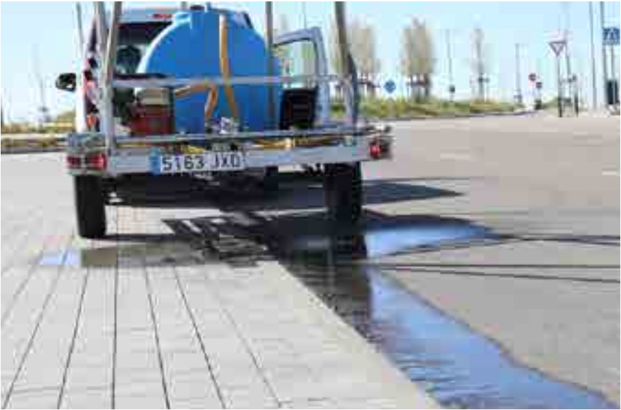
Test de drenaje en el que se compara el pavimento ECOAQUA ™ con el asfalto, siendo evidente la diferencia
